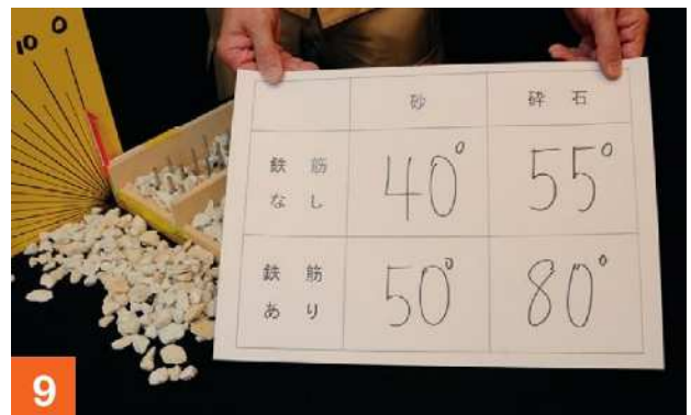
写真 6 鉄筋と地盤のすり抜け実験結果
