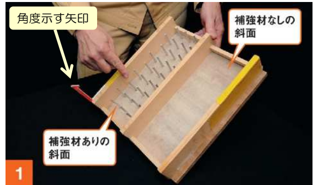
写真 5 鉄筋と地盤のすり抜け実験の装置
