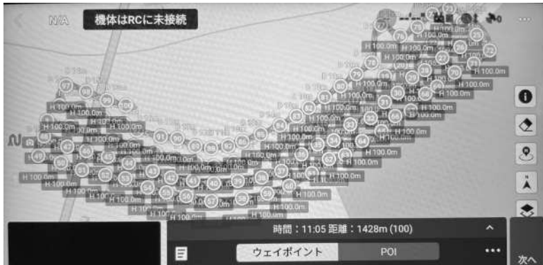
図-1. 写真撮影ルート図(ドローン送信機画面)
